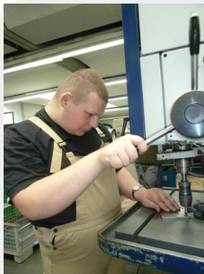
Marco bohrt Löcher in Metallplatten
